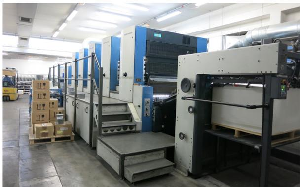
Ces plaques sont ensuite insérées dans la presse. Pour ce type d'impression, Grafiche AZ dispose d'une KBA Rapida 142 à 5 groupes d'impression
